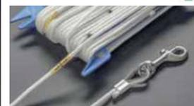
Zur Bestimmung der Sichttiefe und Lichtdurchlässigkeit des Wassers. Zum besseren Absenken mit einem Senkblei versehen. Der ca. 15 cm hohe Steg ist mit einer Öse zur Aufnahme der Senkleine ausgestattet. Die Senkleine ist im Abstand von 100 cm mit Ziffern von 1 bis 10 markiert, sowie zusätzlich dazwischen nach 50 cm mit Strichmarkierungen, damit kann beim Herablassen der Sichtscheibe die Sichttiefe abgelesen werden.
