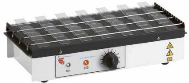
Objektträger-Trockenbank hilft bei der Herstellung von Objektträgern in der Probenmontage. Es ergibt mit dem Paraffin Wachsspender und dem Wasserbad für Paraffinschnitte einen kompletten Satz für das moderne Labor. Für bis zu 50 Objektträger (26 x 76 mm). Beschleunigt die Präparation von Objektträgern, die in verschiedenen Positionen aufgebracht werden können auf den Ablagestäben, an die Ablagestäbe gelehnt flach oder aufgelegt ohne Stäbe.
