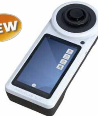
Das Photometer mit 18 verschiedenen Wellenlängen (3 Sensoren mit je 6 Wellenlängen) deckt das gesamte sichtbare Spektrum, sowie wichtige Teile des UV- und IR-Spektrums ab. LEDs sind sowohl bei 180° als auch bei 90° angeordnet, um die nephelometrische Messung der Trübung (NTU), PTSA- und Fluorescein-Messungen zu ermöglichen.
