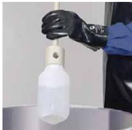
Grau. Für Probenahmen aggressiver Flüssigkeiten, wie Säuren, Laugen, Reiniger. Die Probe fließt direkt in die aufgeschraubte Original-Probeflasche. Der Flaschenverschluss mit Originalitäts-Sicherheitsring gewährt unverfälschten Probentransport.
