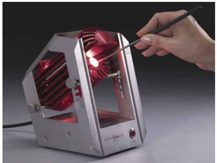
Sterilisation durch Licht. Zum Ausglühen von Impfösen, Pinzetten oder Kleininstrumenten in Sekunden.
