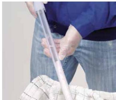
Für Querschnittsproben von pulvrigen oder leicht kohäsiven Substanzen. In vielen Bereichen kommt es auf eine rasche und absolut kontaminationsfreie Probenahme an. Im Reinraum gefertigt, einzeln verpackt. Optional Gammastrahlen-sterilisiert.
